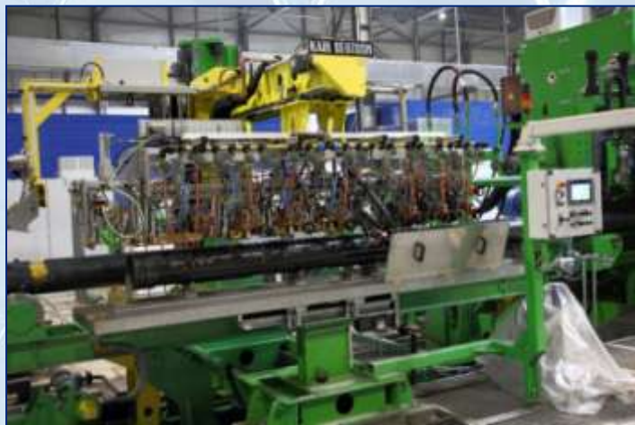
Ультразвуковой контроль шва Производитель: KARL DEUTSCH (Германия)
