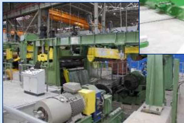
Агрегат продольной резки Производитель: LDM (Италия)
