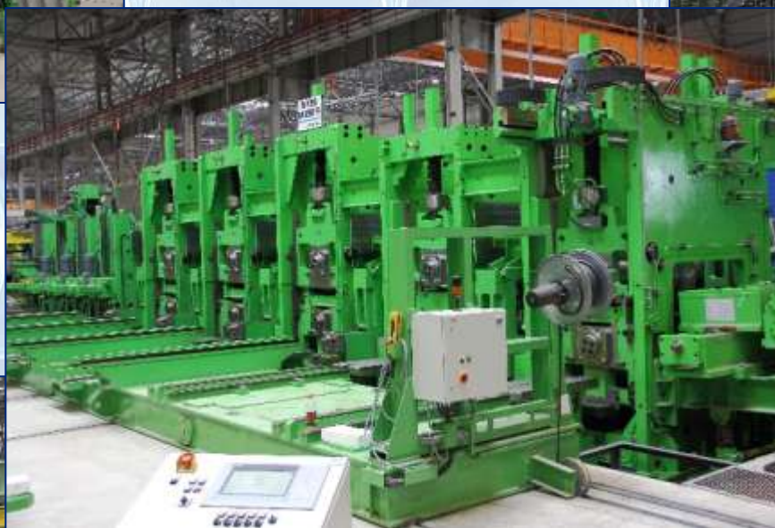
Трубоэлектросварочный стан Производитель: SMS MEER (Германия)
