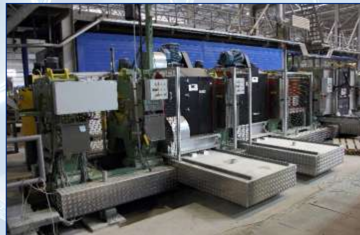
Ультразвуковой и магнитный контроль тела Производитель: MAC (Швеция, США)
